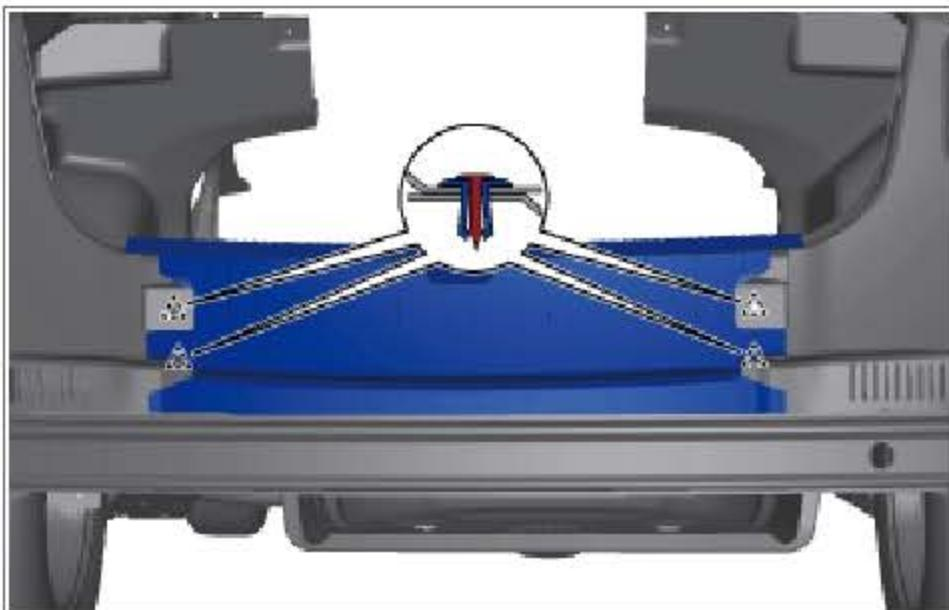
安装行李箱后围护板 4 个固定卡扣。
