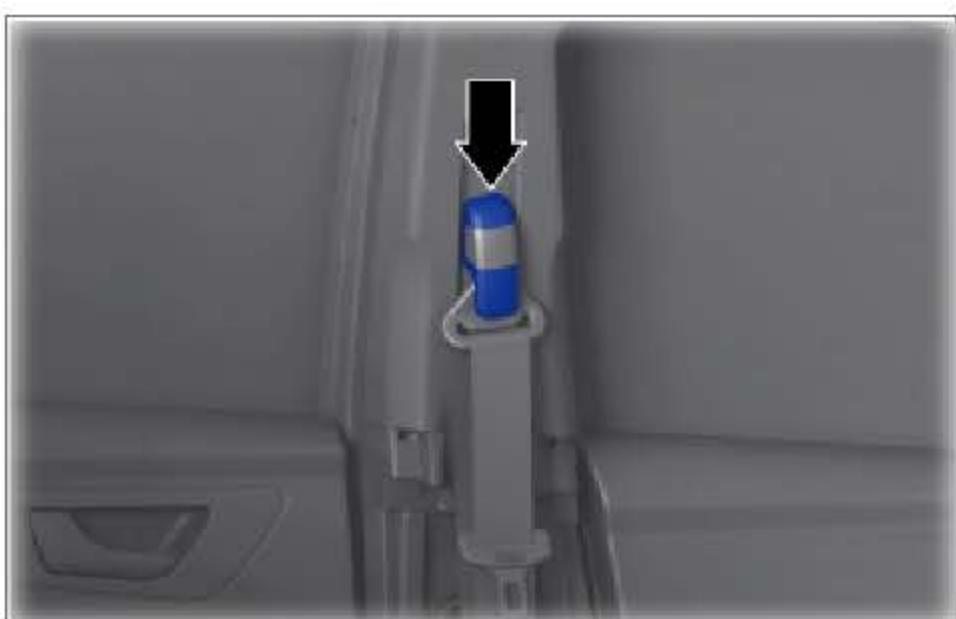
拆下安全带高度调节器盖板。
