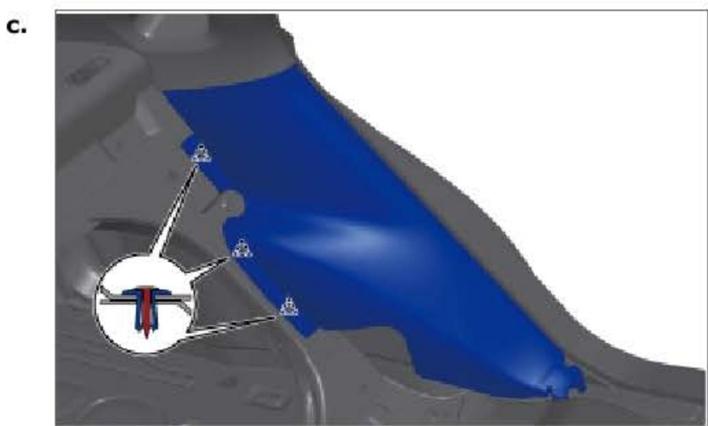
拆下 C 柱下护板 3 个固定卡扣。
