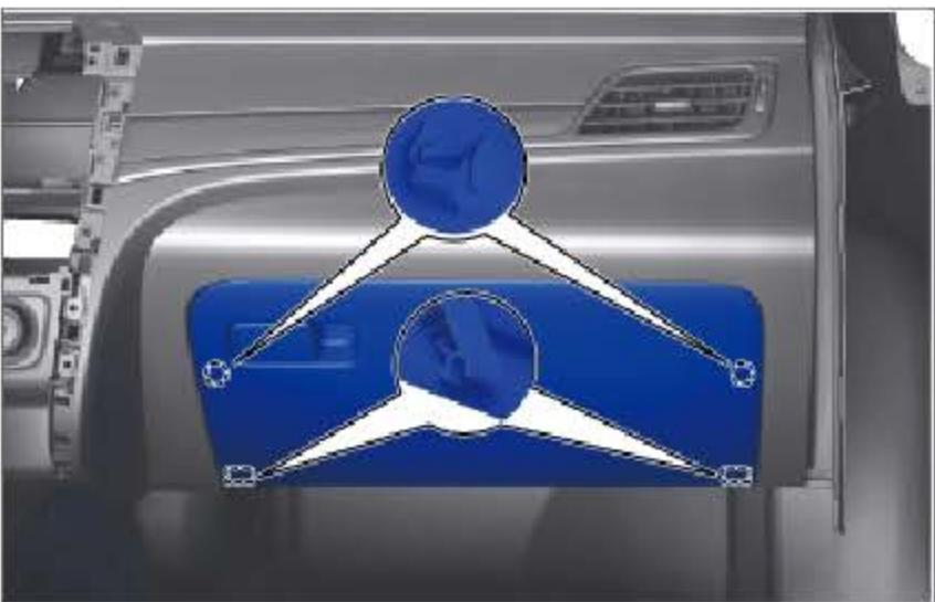
脱开两侧定位销和限位挡块，并取下储物盒总成。
