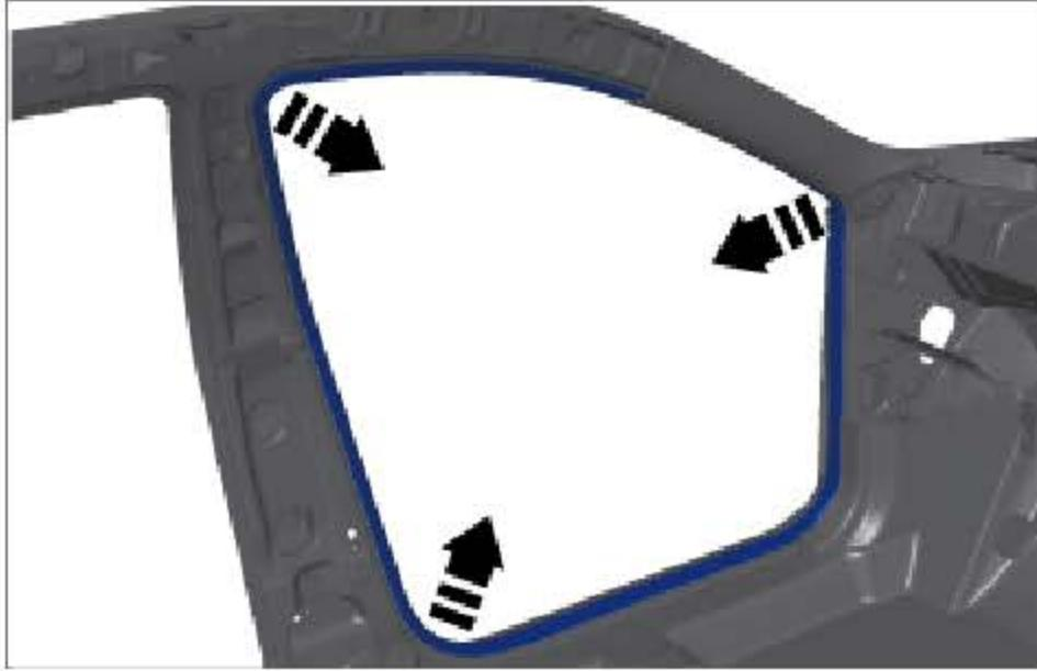
分离门洞密封条, 拆下左前门洞密封条。
