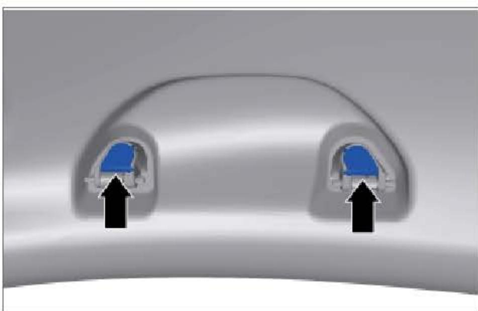
安装顶棚拉手螺钉罩盖。
