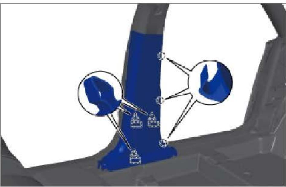
a. 安装 B 柱左下护板，确保 3 个卡扣和 2 个卡爪安装到位。
