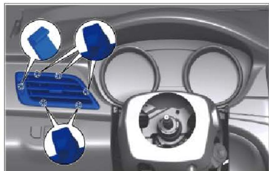
安装仪表板左侧出风口总成，确保 6 个卡爪安装到位。
