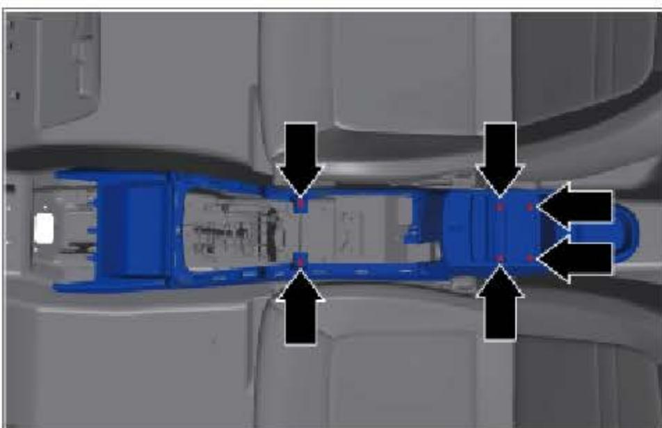
安装副仪表板总成 6 个固定螺钉。
