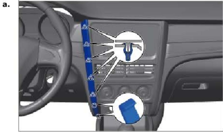
分离 5 个卡扣和 2 个卡爪，并拆下仪表板左中装饰板总成。
