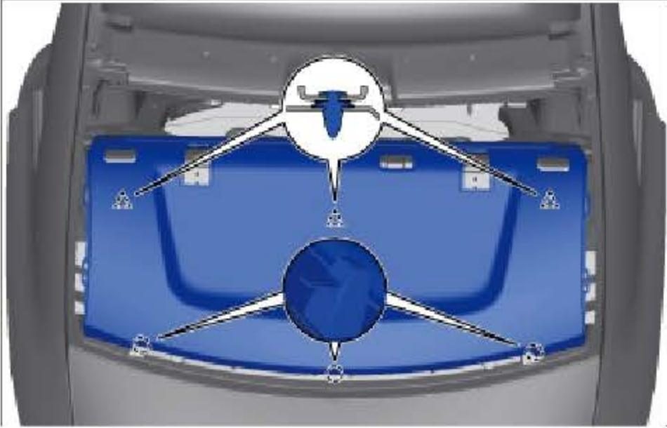
分离 3 个卡扣和 3 个卡爪，拆下包裹架护板。
