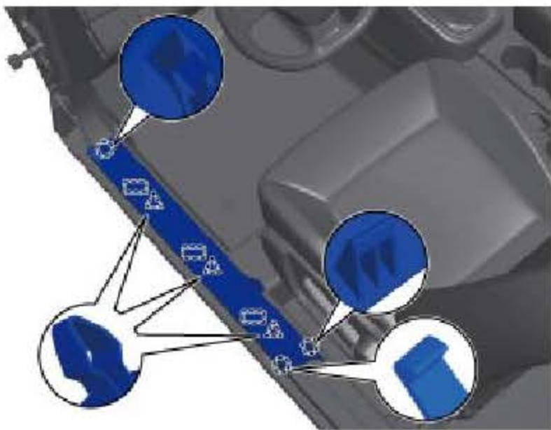
**a.** 安装左前门槛装饰板，确保 3 个卡扣和 4 个卡爪安装到位。
