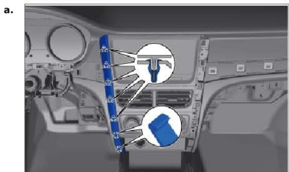
安装左中装饰条，确保 5 个卡扣和 2 个卡爪安装到位。
