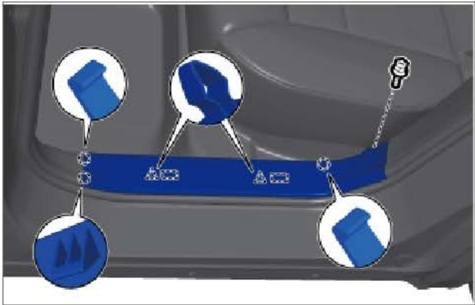
a. 安装左后门槛装饰板，确保 2 个卡扣安装到位。
