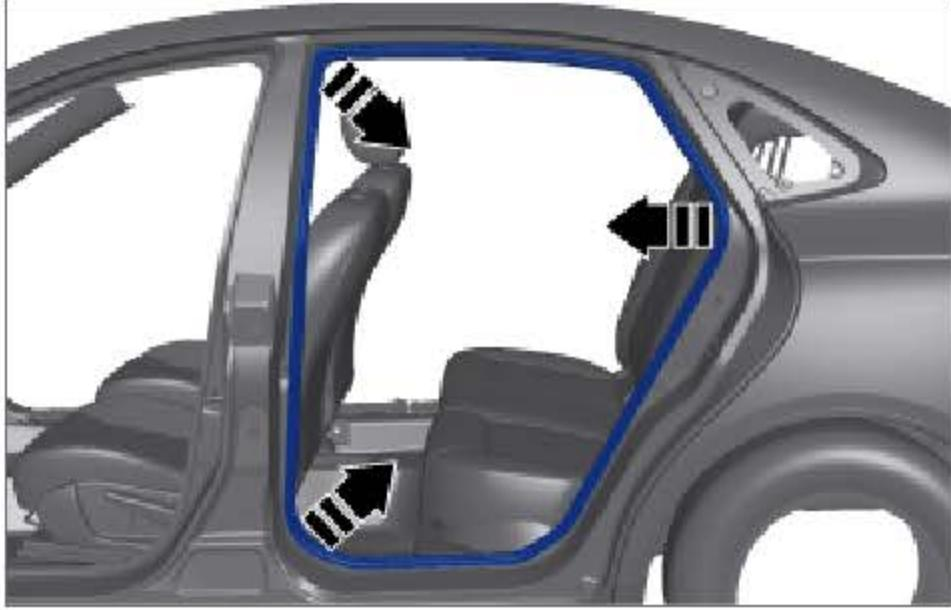
分离门洞密封条，拆下左后门洞密封条。
