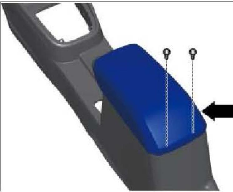
安装扶手总成，并安装扶手总成 2 个固定螺钉。
