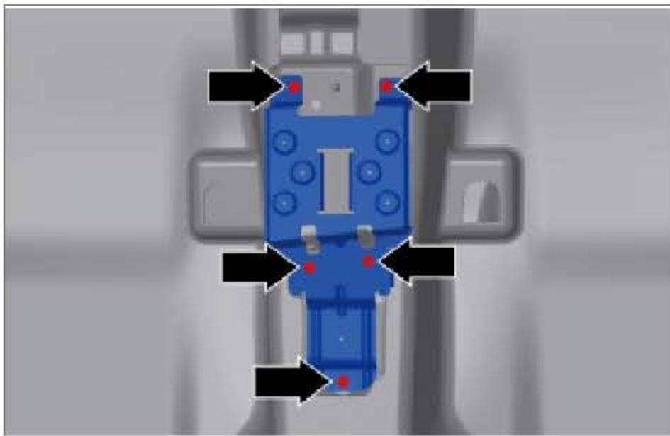
安装副仪表板后部固定支架，并安装 3 个固定螺母和 2 个固定螺栓。
