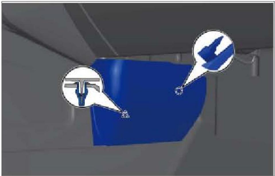
**a.** 安装右前延伸板总成，确保卡扣和卡爪安装到位。
