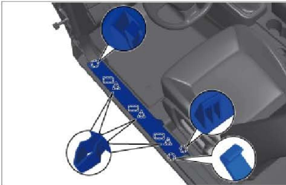
向上拉动左前门槛装饰板分离 3 个卡扣和 4 个卡爪, 并拆下左前门槛装饰板。
