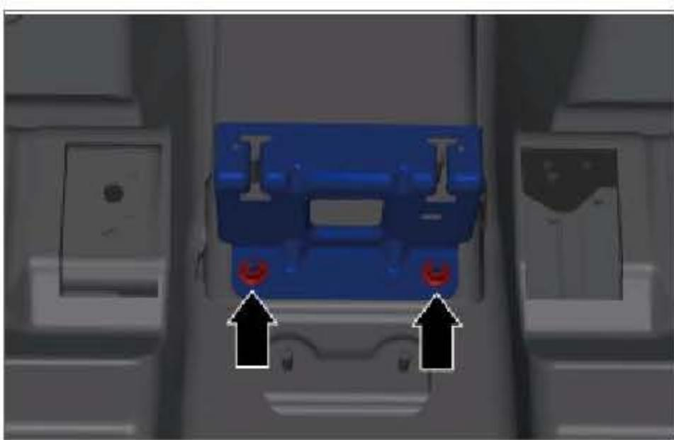
拆下 2 个螺母，并拆下副仪表板中部固定支架。
