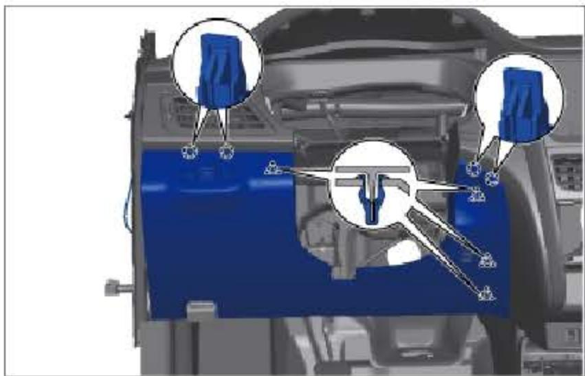
安装仪表板左下护板总成，确保 4 个卡扣和 4 个卡爪安装到位。
