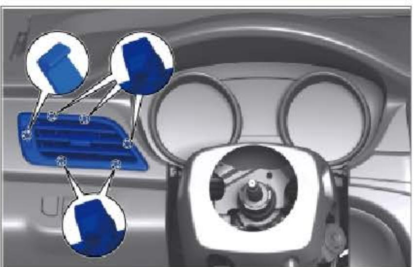
分离 6 个卡爪并拆卸仪表板左侧出风口总成。
