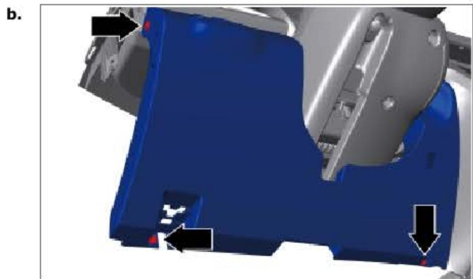
拆下仪表板左下护板总成的 3 个螺钉。
