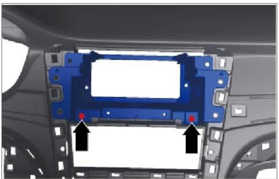
拆下 2 个螺钉，并拆下中央功能框架。
