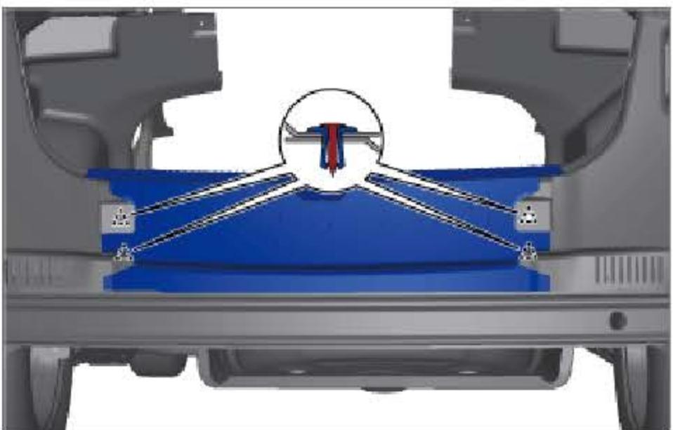
拆下行李箱后围护板 4 个固定卡扣。
