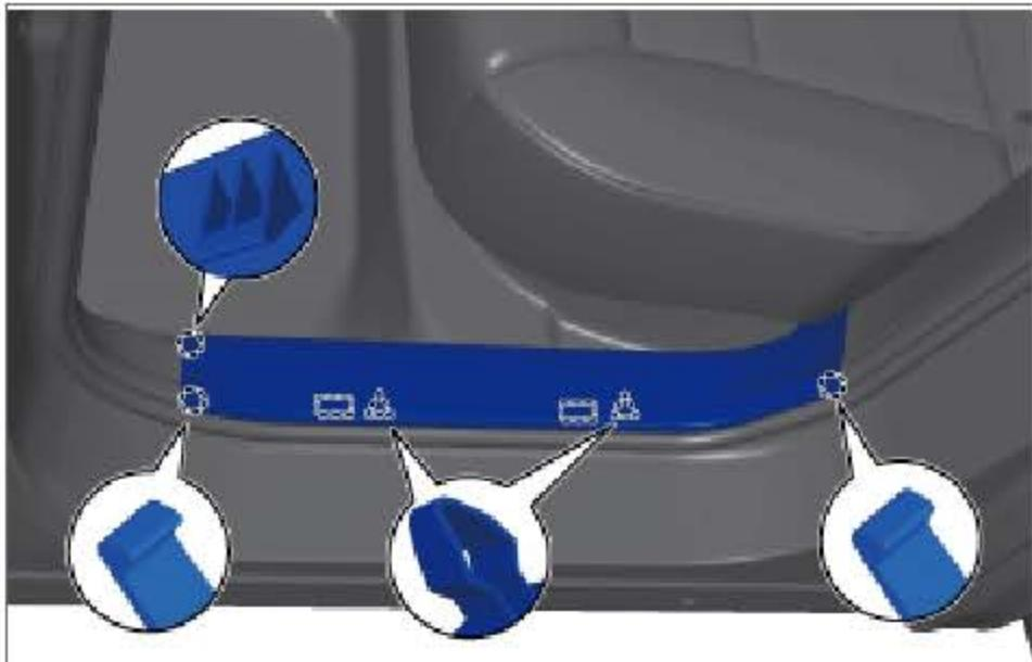
向上拉动左后门槛装饰板分离 2 个卡扣，拆下左后门槛装饰板。
