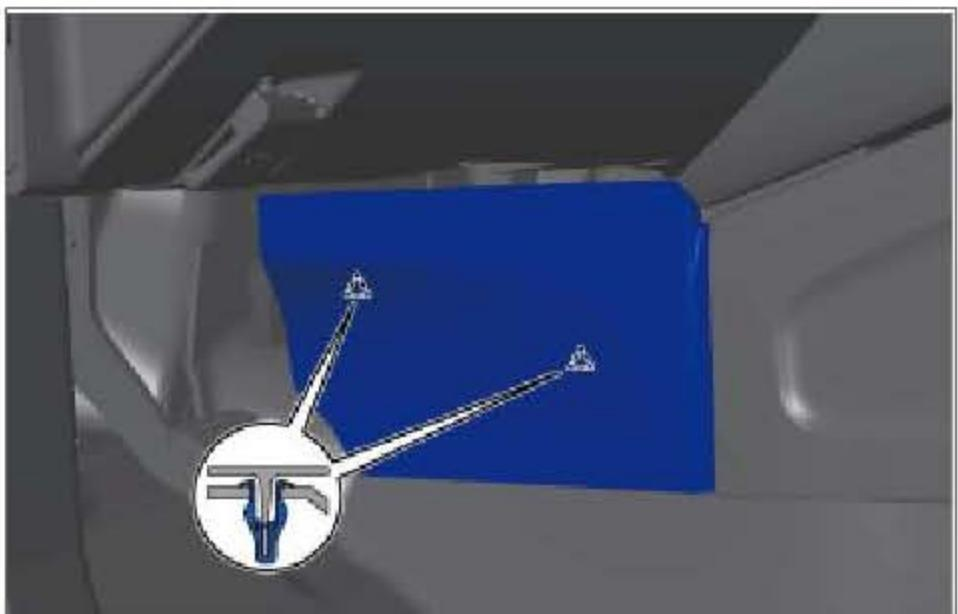
**a.** 安装左前延伸板总成，确保 2 个卡扣安装到位。
