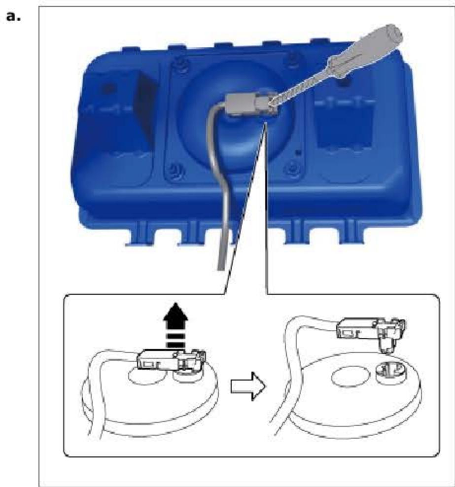
使用头部缠有保护胶带的螺丝刀，松开安全气囊连接器锁止件。
