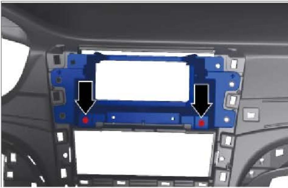
安装中央功能框架，并安装 2 个螺钉。
