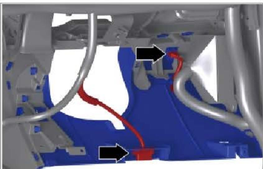
断开 ESP 和前大灯高度调节开关连接器，拆下诊断接口。
