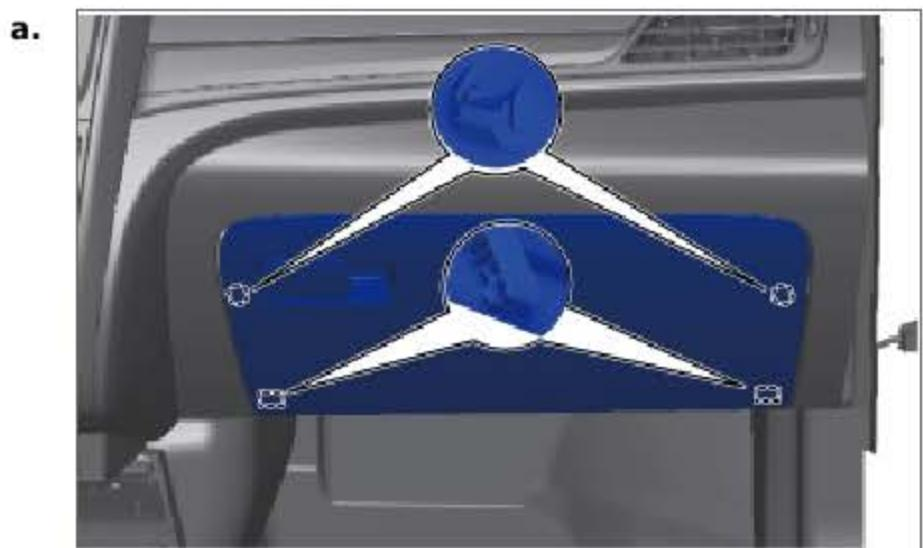
安装储物盒总成并安装两侧定位销。
