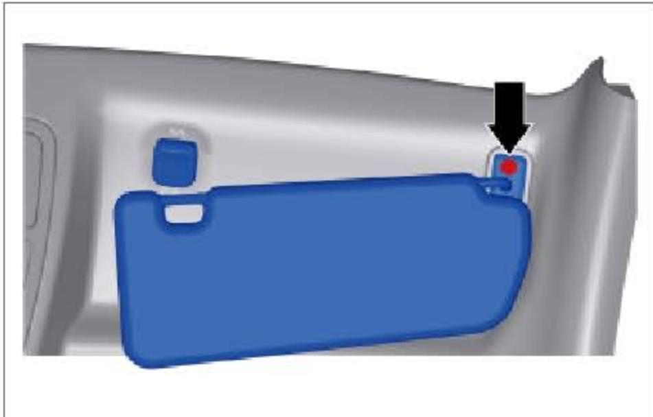
拆下螺钉，并取下遮阳板。
