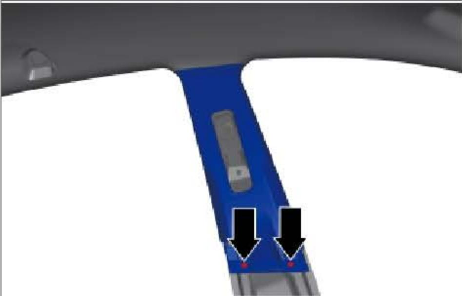
a. 安装 B 柱左上护板，确保卡爪安装到位。
