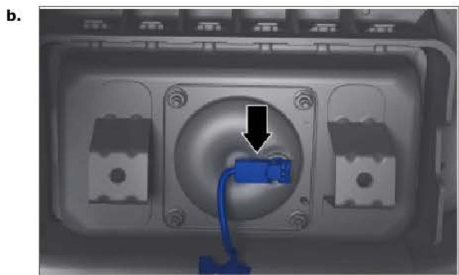
断开副驾驶员侧安全气囊连接器。
