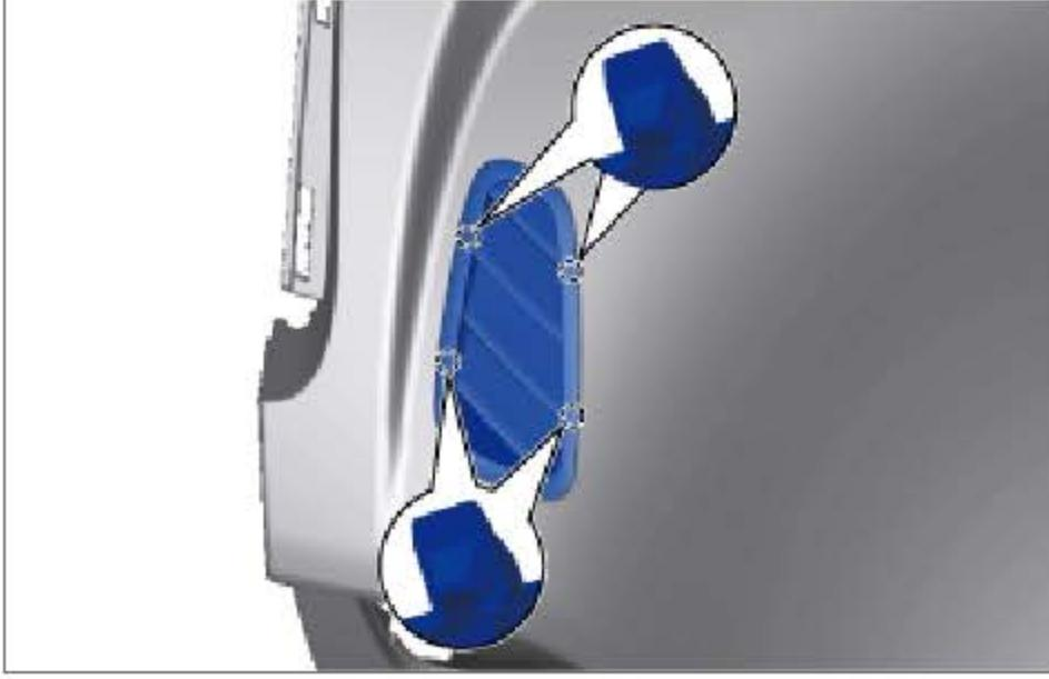
安装左侧除霜喷嘴，确保卡爪安装到位。
