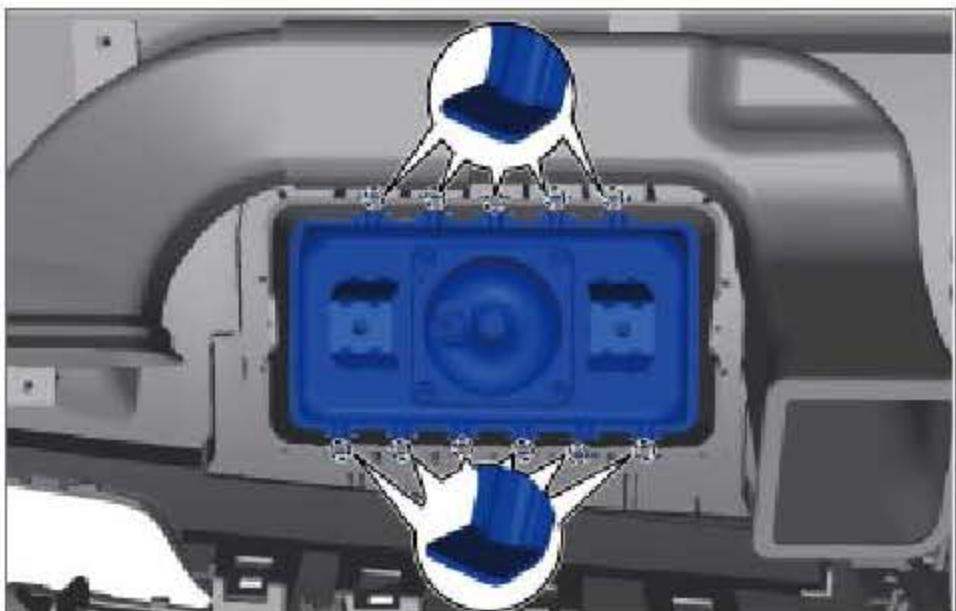
安装副驾驶安全气囊总成，确保卡爪安装到位。
