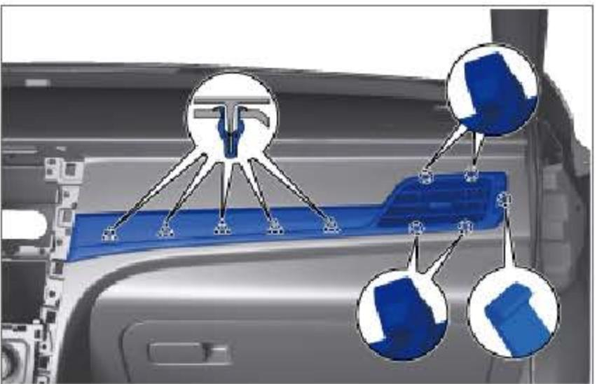
分离 5 个卡扣和 5 个卡爪并拆卸仪表板右侧出风口总成。
