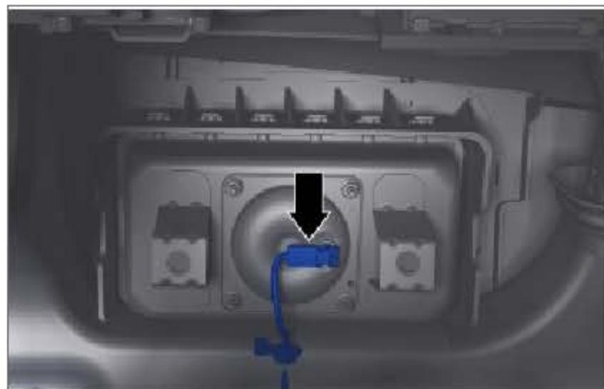
安装副驾驶员侧安全气囊连接器。
