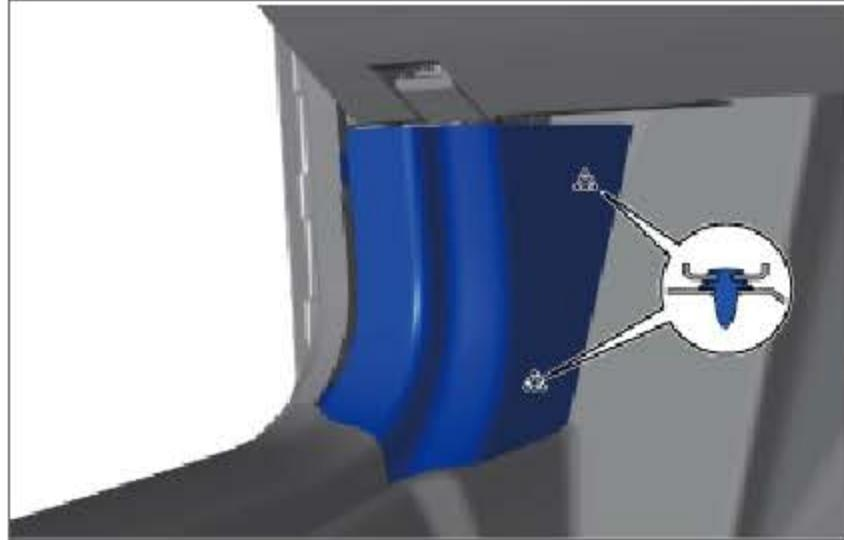
分离 2 个卡扣，并拆下左侧 A 柱下护板。
