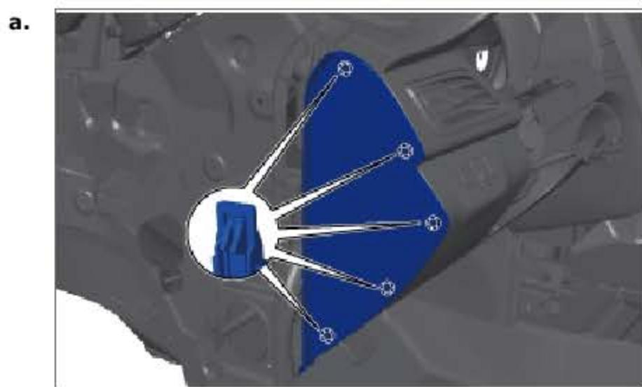
安装左侧端盖，确保 5 个卡爪安装到位。
