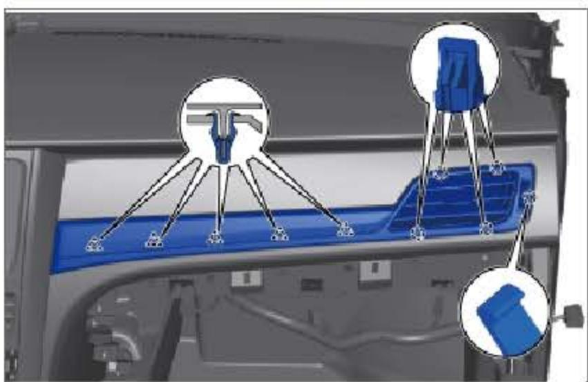
安装仪表板右侧出风口总成，确保 5 个卡扣和 5 个卡爪安装到位。
