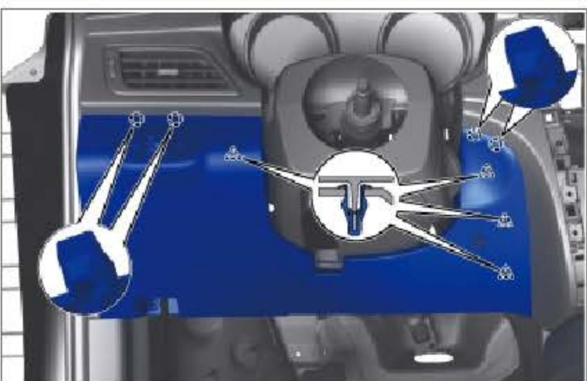
分离 4 个卡扣和 4 个卡爪，并拆下仪表板左下装饰板总成。
