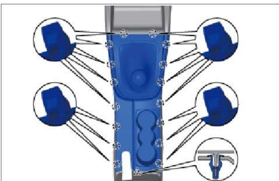
安装换档盖板总成，确保卡扣和 16 个卡爪安装到位。
