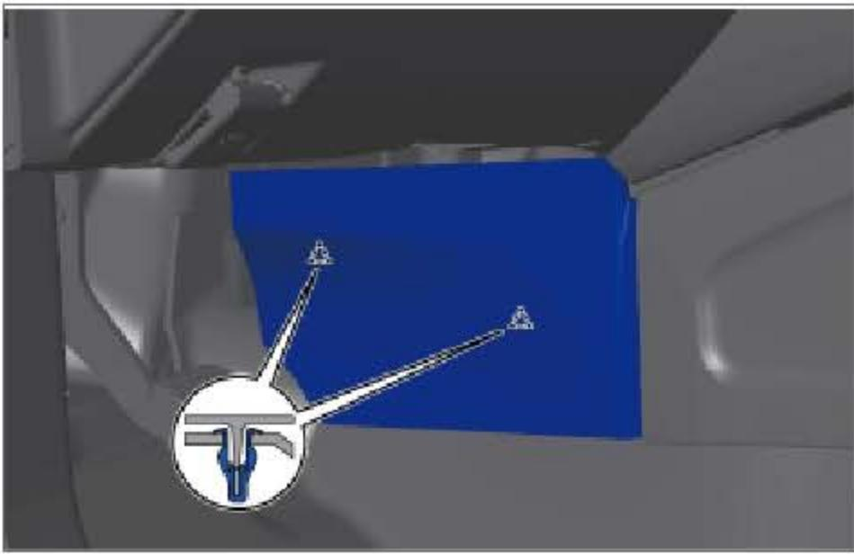
分离 2 个卡扣，拆下左前延伸板总成。
