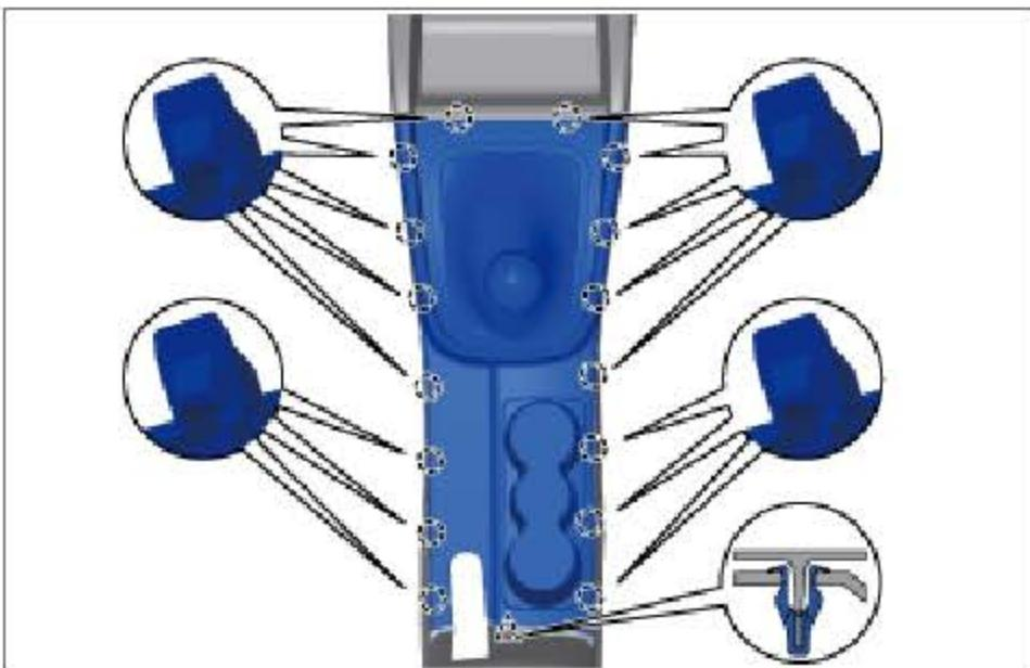
分离卡扣和 16 个卡爪，拆下换档盖板总成
