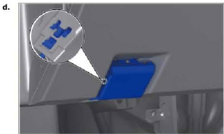
安装发动机舱开启手柄，确保卡爪安装到位。
