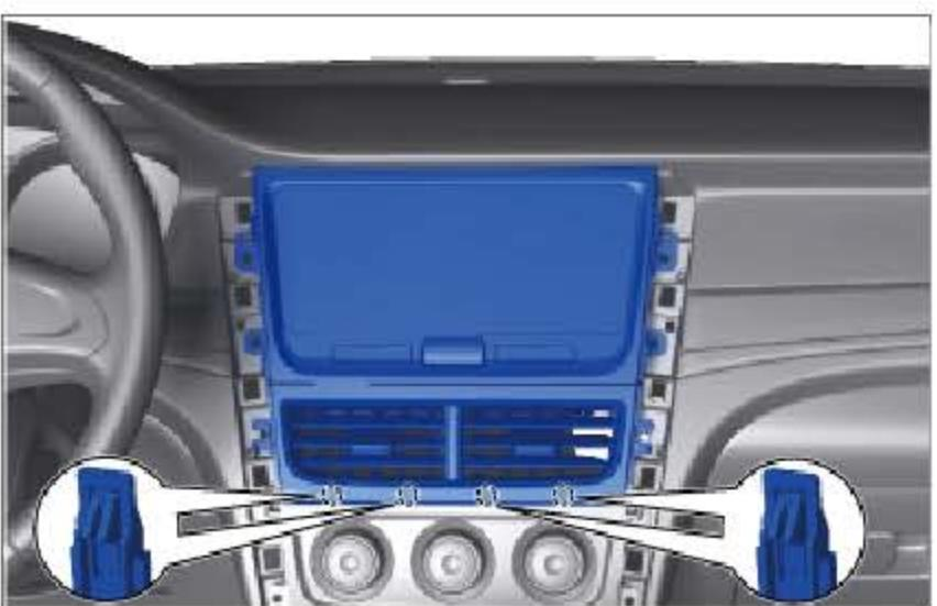
分离 4 个卡爪，并拆下音响总成带中央出风口总成。
