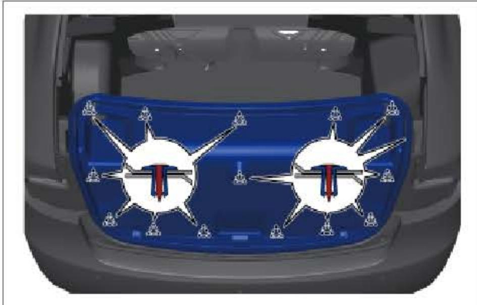
拆下行李箱盖护面 14 个固定卡扣。
