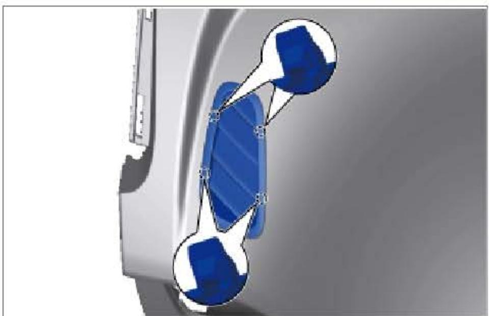
使用头部缠有保护胶带的螺丝刀，分离 4 个卡爪并取下左侧除霜喷嘴。
