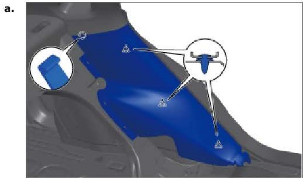
安装 C 柱左下护板，确保 3 个卡扣和 1 个卡爪安装到位。
