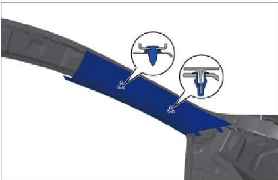
分离 2 个卡扣，并取下 A 柱左上护板。
