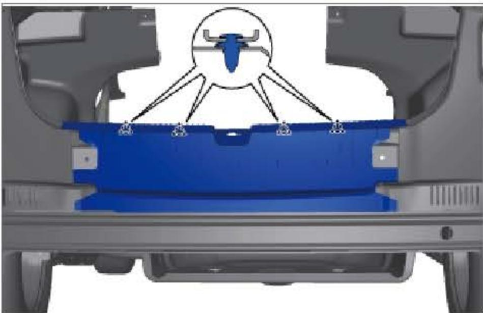
安装行李箱后围护板，确保 4 个卡扣安装到位。
