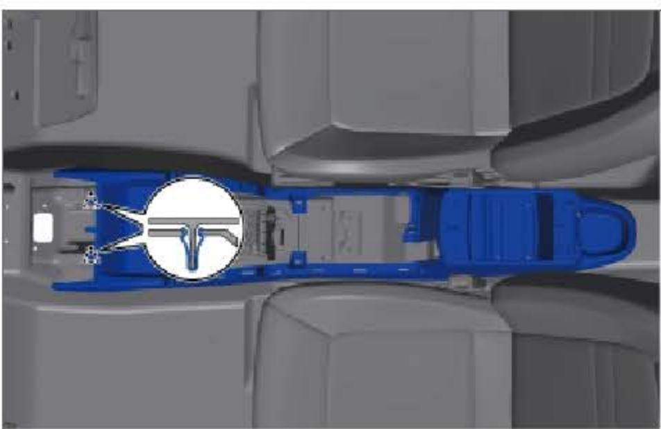
安装副仪表板总成，确保 2 个卡扣安装到位。
