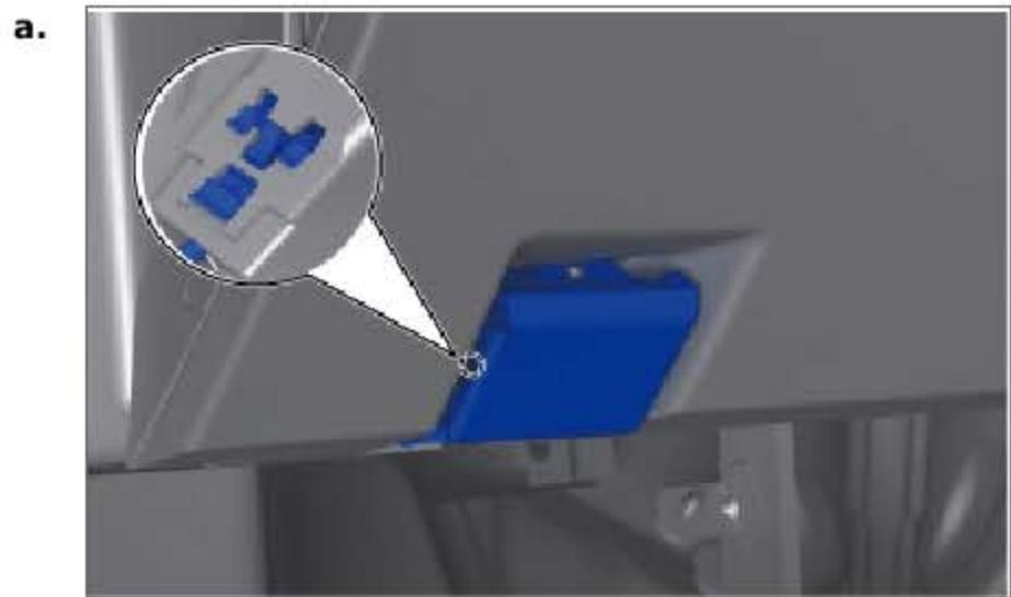
分离 4 个卡爪，拆下发动机罩开启手柄。
