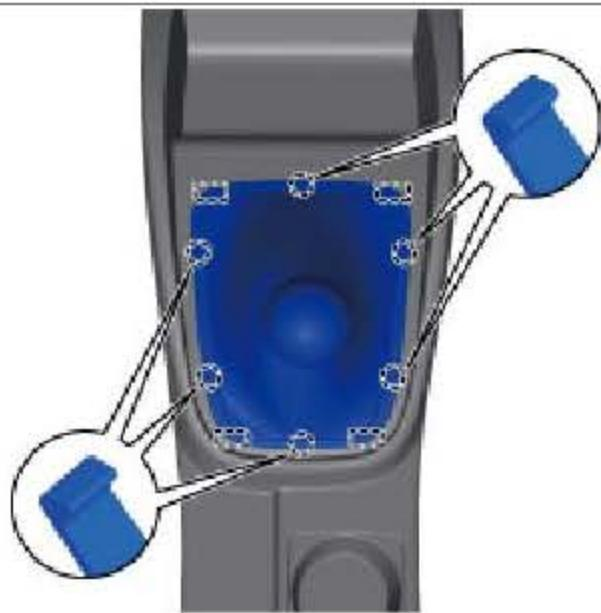
安装换档手柄及皮裙总成，确保 6 个卡爪安装到位。
