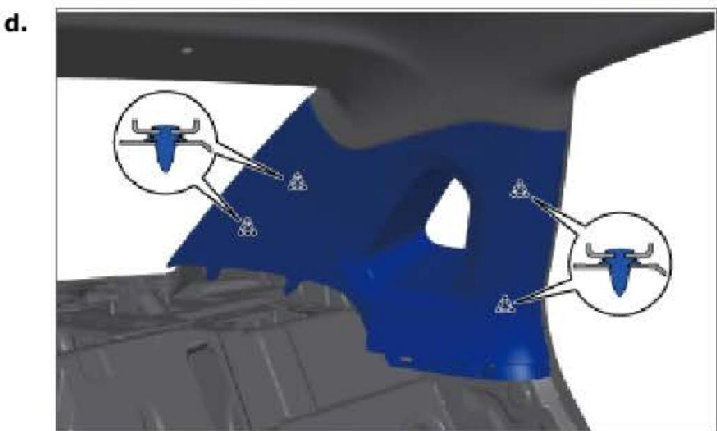
向内拉动 C 柱左上护板分离 4 个卡扣，拆下 C 柱左上护板。
