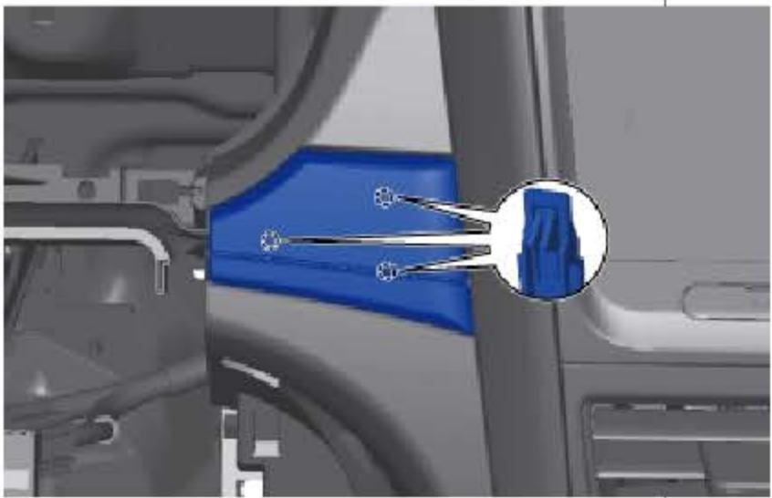
安装仪表板中装饰板，确保 3 个卡爪安装到位。
