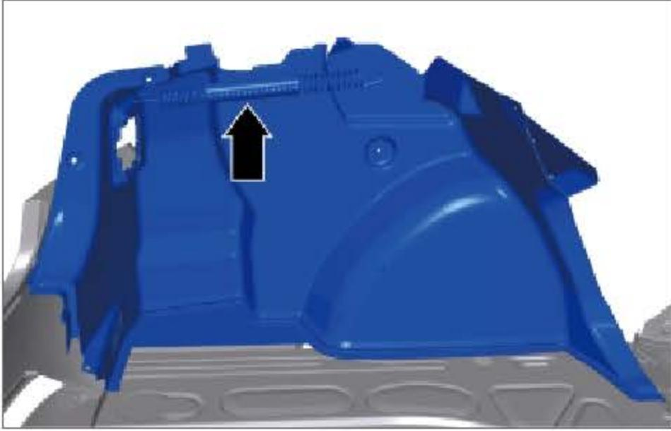
安装行李箱左侧护面并安装行李箱盖左侧拉簧总成。
