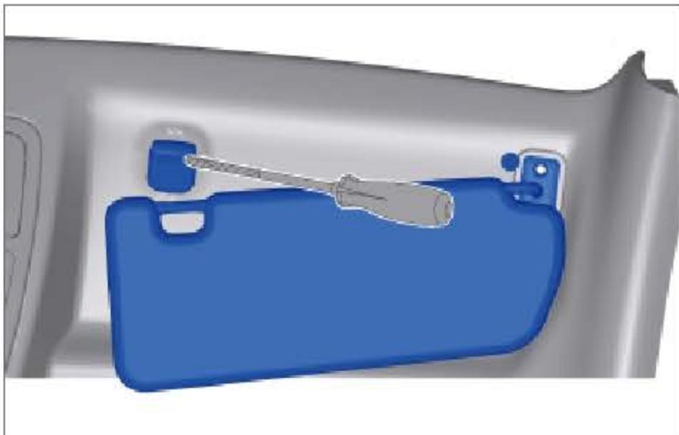
将螺丝刀插入遮阳板固定座槽口，拆下遮阳板固定座。
