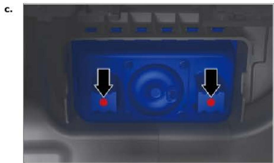
拆下副驾驶员侧安全气囊 2 个固定螺栓。
