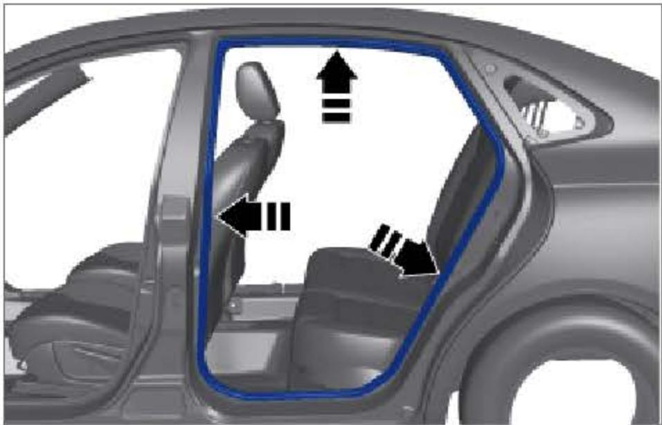
a. 安装左后门洞密封条。
