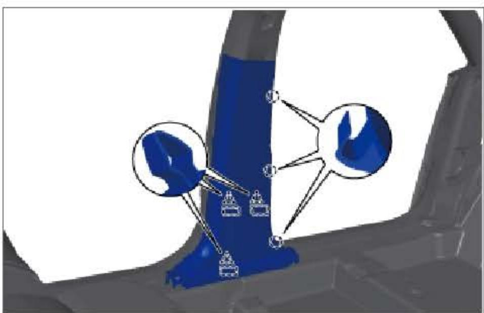
拉动 B 柱左下护板分离 3 个卡扣和 2 个卡爪，拆下 B 柱左下护板。
