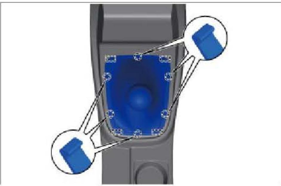
分离 6 个卡爪，拆下换档手柄及皮裙总成
