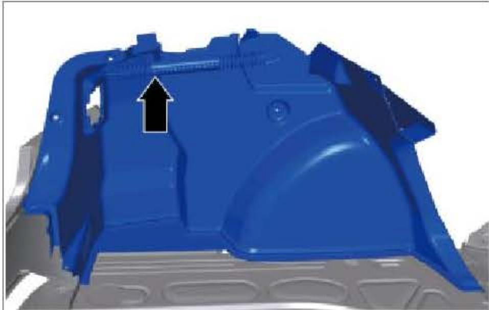
拆下箱盖左侧拉簧总成并取出行李箱左侧护面。
