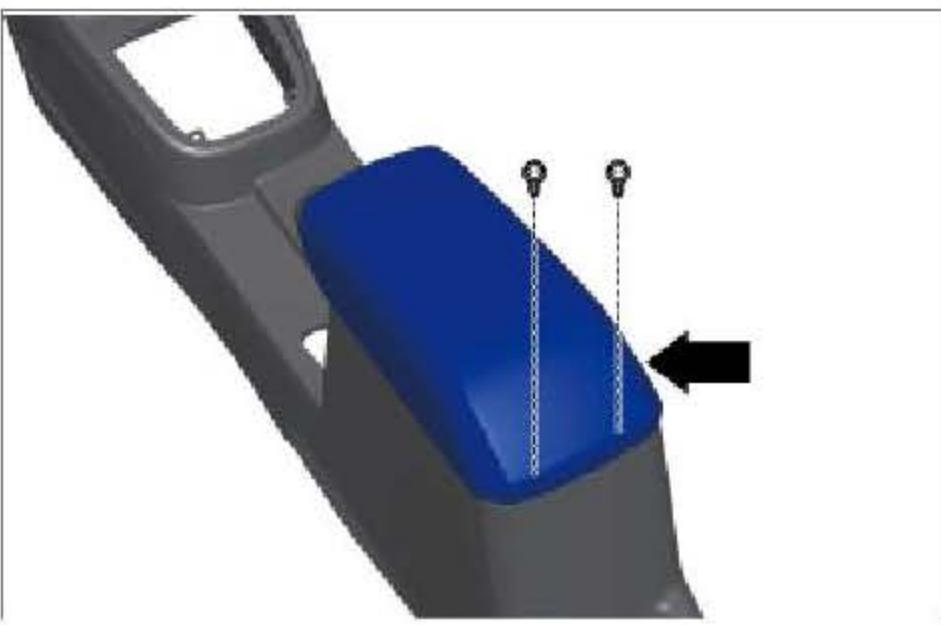
拆下扶手总成 2 个固定螺钉，并拆下扶手总成。
