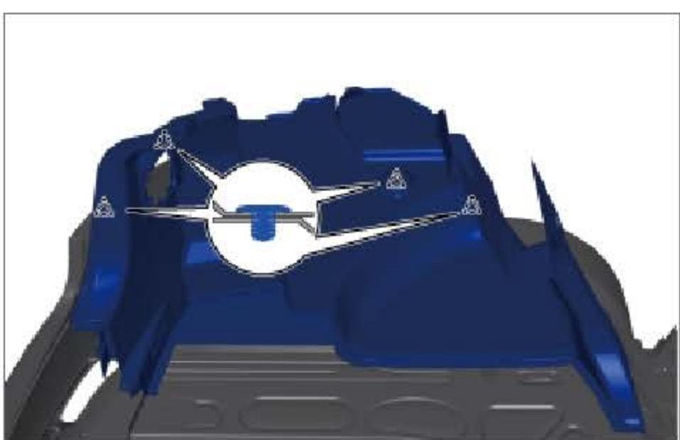
拆下行李箱侧护面 4 个固定卡扣。
