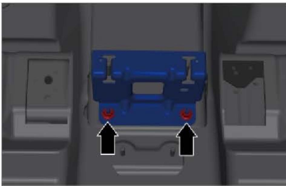
安装副仪表板中部固定支架，并安装 2 个固定螺母。
