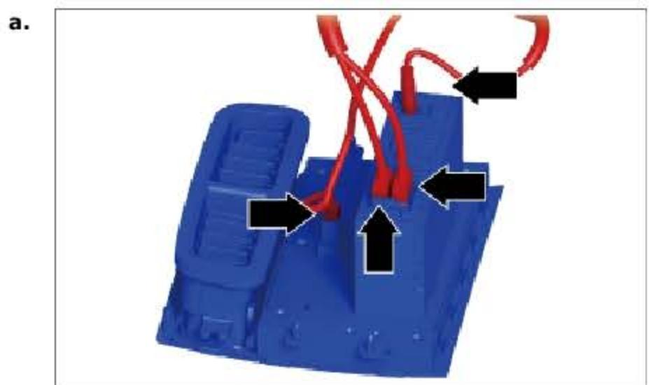
安装音响总成和危险信号灯开关连接器。
