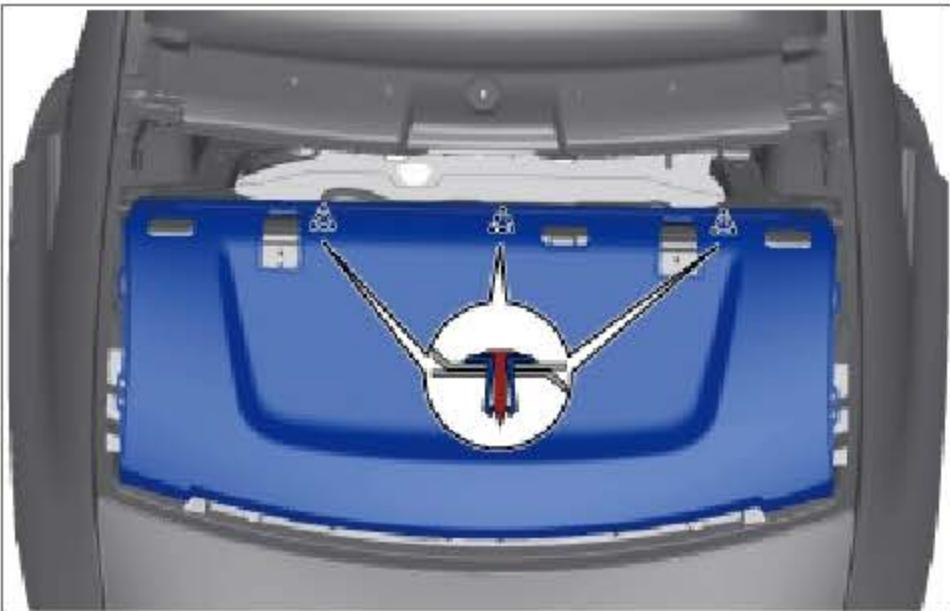
拆下包裹架护板前部 3 个固定卡扣。
