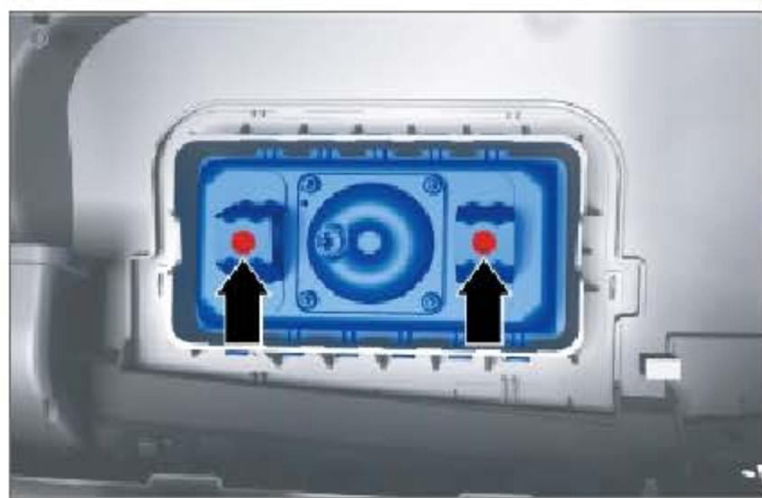
安装副驾驶员侧安全气囊 2 个固定螺栓。
