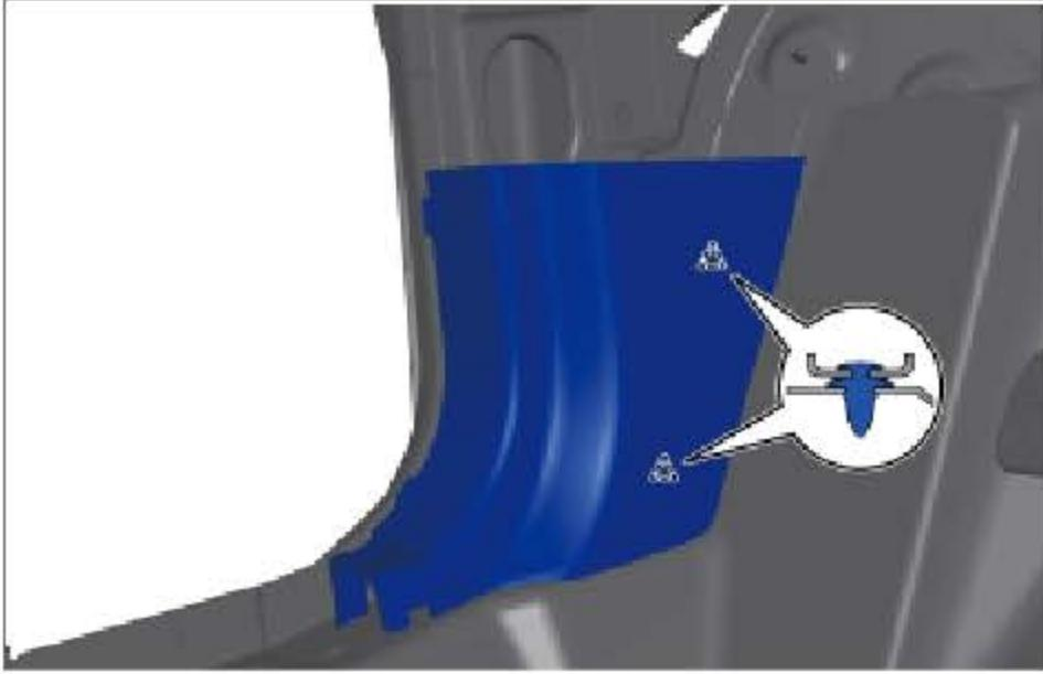
分离 2 个卡扣，向内拉动 A 柱下护板以将其拆下。
