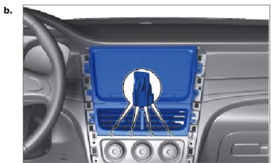
安装音响总成带中央出风口总成，确保 4 个卡爪安装到位。
