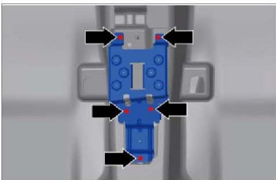
拆下 2 个螺栓和 3 个螺母，并拆下副仪表板后部固定支架。
