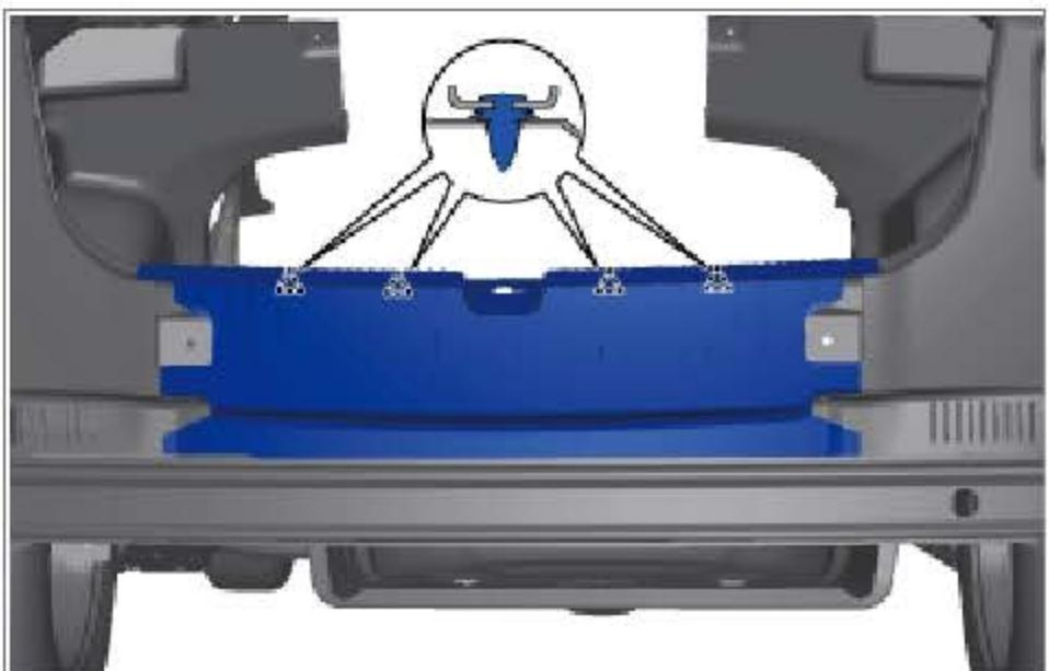
分离 4 个卡扣，并拆下行李箱后围护板。
