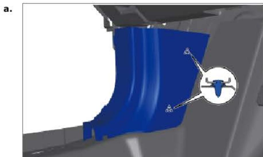
安装左侧 A 柱下护板，确保 2 个卡扣安装到位。
