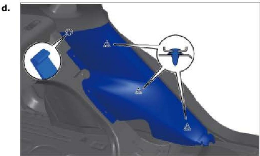
分离 3 个卡扣和 1 个卡爪，拆下 C 柱下护板。
