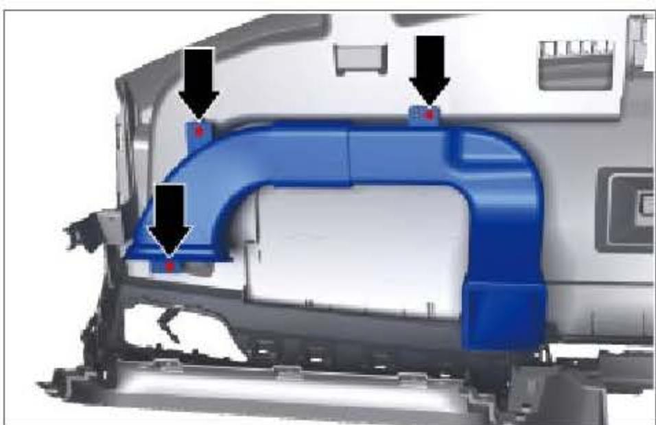
安装右吹面风道并安装 3 个螺钉。
