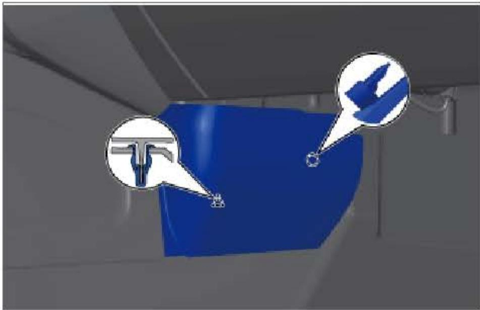
分离卡扣和卡爪，拆下右前延伸板总成。
